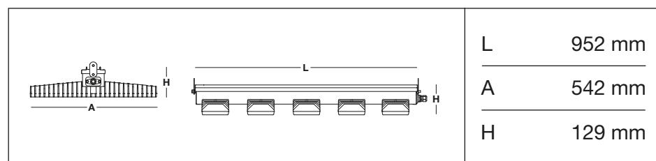
**Apparecchio industriale ad alto flusso luminoso ed elevata efficienza luminosa progettato con le più innovative tecnologie per ambienti con temperatura fino a 55°C.**
