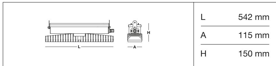
**Apparecchio industriale ad alto flusso luminoso ed elevata efficienza luminosa progettato con le più innovative tecnologie per ambienti con temperatura fino a 40°C.**
