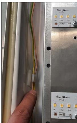
**12** Rimuovere 2 dei 4 scrocchi (1 per lato in maniera contrapposta) agendo con una pinza per allargare le linguette e installare i 2 "scrocchi" a corredo.
